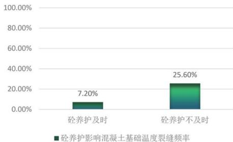
图 6.1 砼养护影响混凝土基础温度裂缝柱状图
